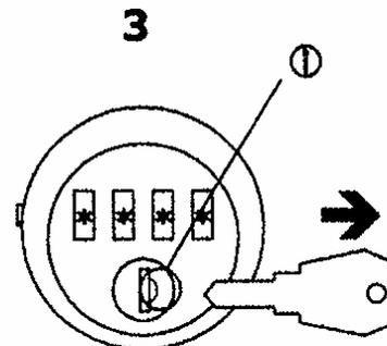
**Attention!** Avant de retirer la clé, s'assurer impérativement que la cuvette (i) du cylindre se trouve sur la **droite!**
