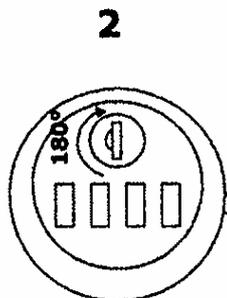
Après que la cavalier se soit engagé dans la rainure dans le stator, tourner la cylindre de 180° avant de retirer la clé.
