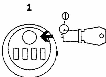
Tourner la serrure de 180°. Introduire la clé dans le cylindre. Introduire celui-ci dans le stator en s'assurant que le cavalier (i) soit bien dirigé vers le haut.
