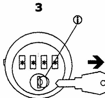
**Attention!** Avant de retirer la clé, s'assurer impérativement que la cuvette (i) du cylindre se trouve sur la **droite!**
